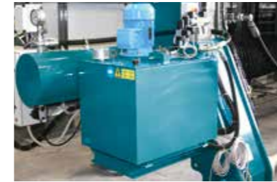
Centralina idraulica di chiusura del pacco piastre
